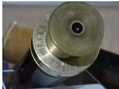
**Abbildung 4:** Graduierte, drehbare Trommel
